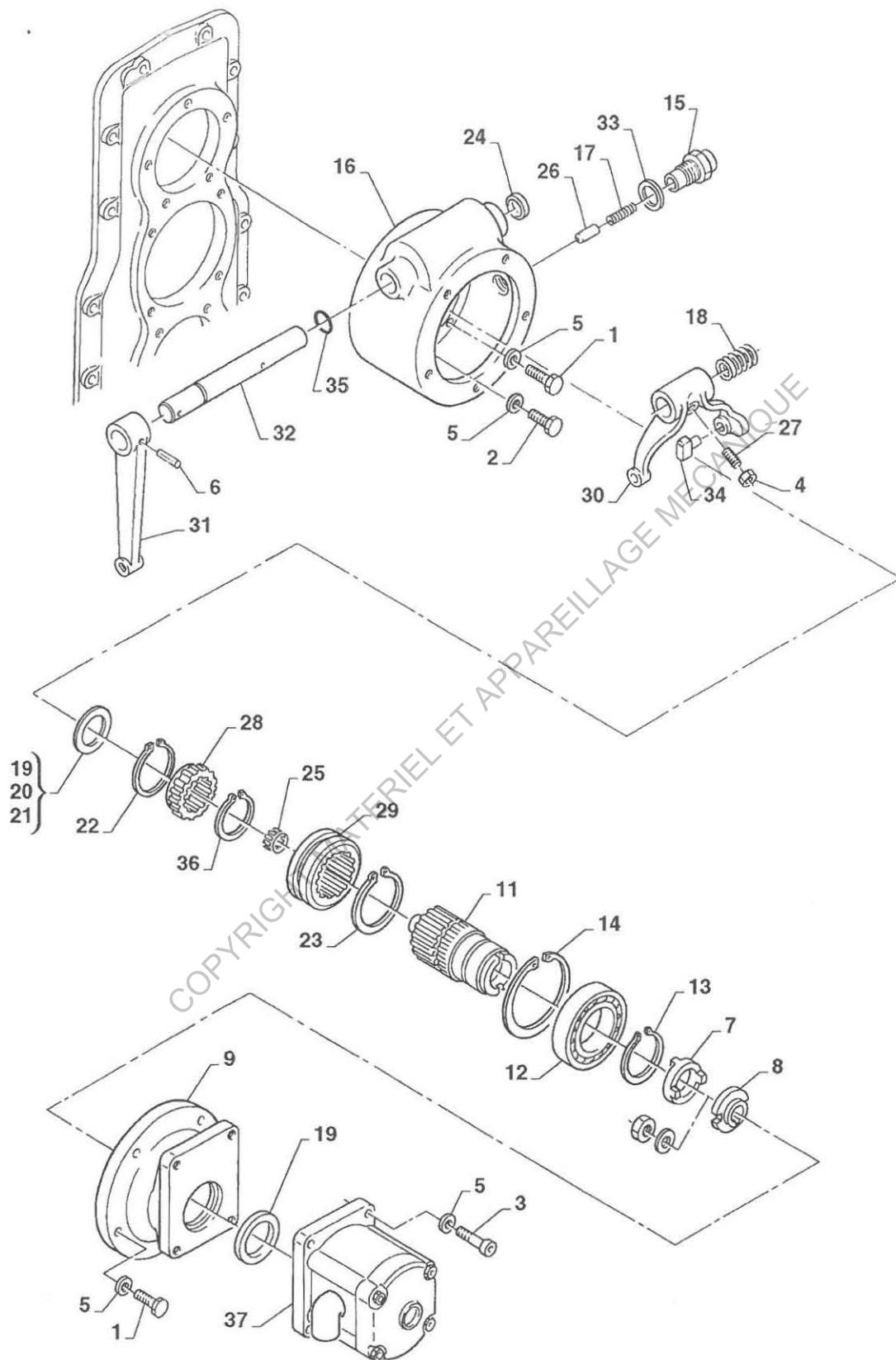
**BREMACH**Presa di forza posteriore sul riduttore con pompa idraulica
